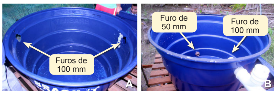
Figura 6. Caixa com os furos do lado direito (entrada do esgoto) e esquerdo (saída do esgoto) (A). Caixa com os furos do lado direito (entrada do esgoto pelo furo superior) e direito (saída do esgoto tratado pelo furo inferior) (B).
