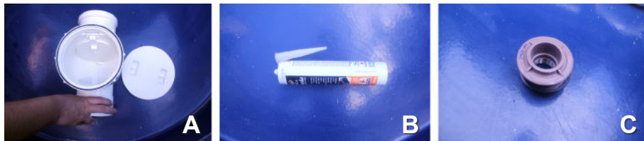
Figura 3. Imagens de materiais menos conhecidos, utilizados na construção do sistema de fossa séptica biodigestora. Válvula de retenção (A), selante de poliuretano (B) e adaptador com flange 50 mm x 1 ½ (C).
