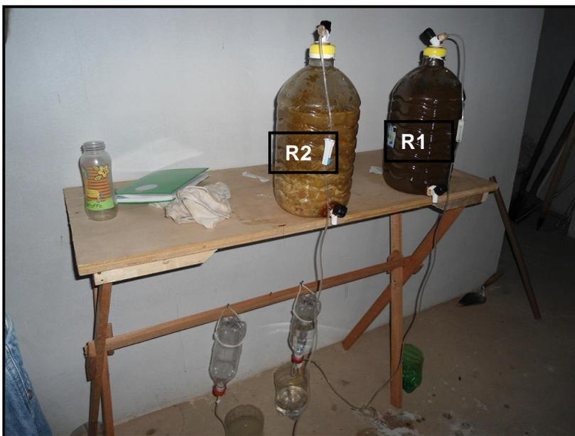
**Figura 1:** Reatores desenhados para a digestão anaeróbia de resíduos sólidos. R1 esterco bovino, R2 mescla de resíduos de alimentos com esterco bovino. Na parte inferior se observam os gasômetros de água de cada reator.
